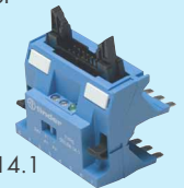
MasterADAPTER zorgt voor gemakkelijke verbinding van de A1/A2 aansluitingen naar de PLC uitgangen via een 14-polige flatcable-connector
